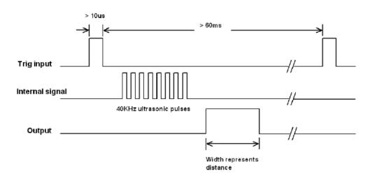
un signal "high" sur la sortie "Echo", dont la durée est proportionnelle à la distance mesurée.
